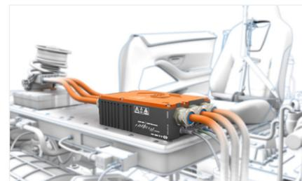
Das HV Breakout-Modul 3.3 misst die Ströme u. Spannungen direkt in den HV-Leitungen zwischen Inverter u. Elektro-Motor.
